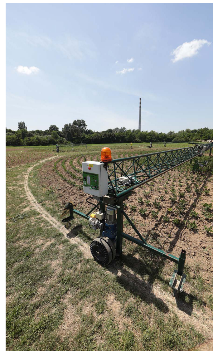
Obr. 119 Agrokruh – prístroj na zníženie zhutňovania pôdy pri obrábaní. Zdroj: Agrokruh, 2024
